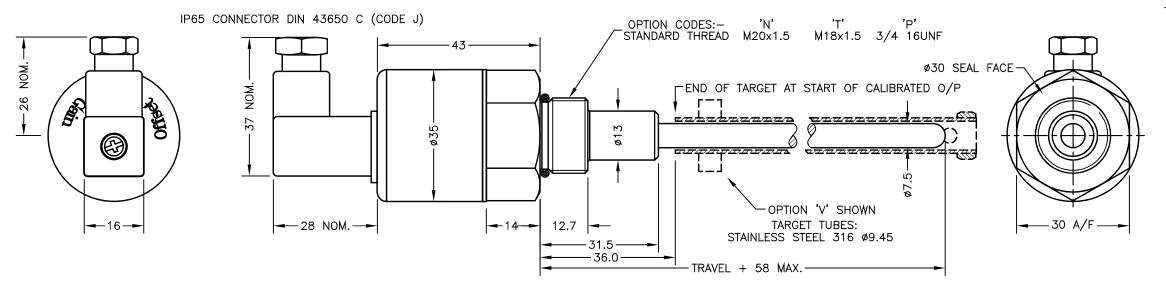
**ELECTRICAL OPTIONS/ SPECIFICATIONS** OUTPUT **SUPPLY** 0.5 TO 4.5V RATIOMETRIC 5V
